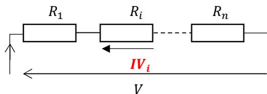
Figure I.12. Diviseur de tension
