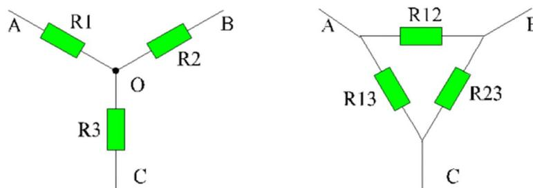
Figure I.19. Equivalence étoile triangle ou bien Pi-Ti
