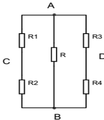
Pour calculer la résistance du réseau vu de **C** et **D**, on transforme un des triangles en étoile, par exemple **ABC**.
