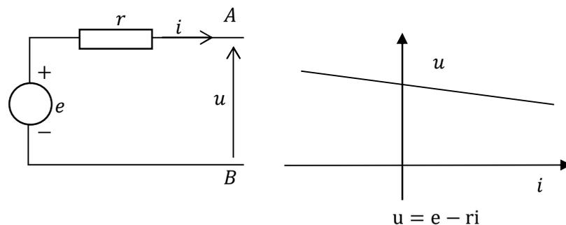
Figure I.15. Générateur réel
