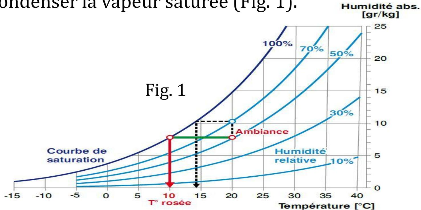
**Le point de rosée** est la température à laquelle l'air doit être refroidi pour que la vapeur d'eau qu'il contient condense en rosée ou en givre.
