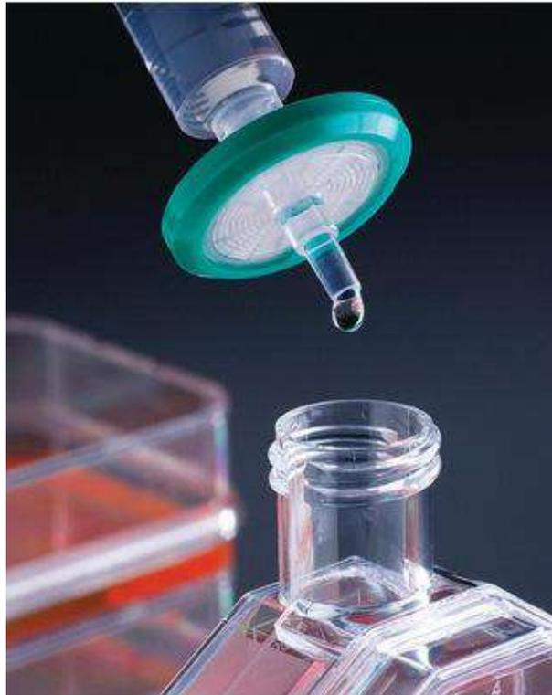
**Figure 5:** Filtration sous pression.
