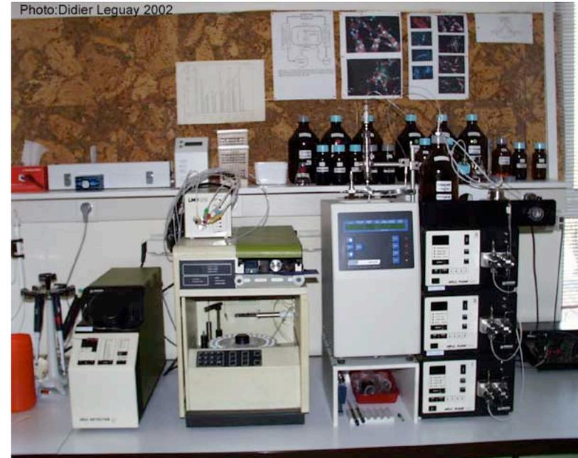
Éléments reliés entre eux par des tubes ( $\varnothing = 0,1 \text{ mm}$ ) en inox ou PEEK®
