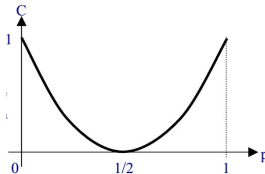
Nous retrouvons les conclusions de l'illustration de la notion de quantité d'information mutuelle : lorsque la probabilité d'erreur est de 50% , la capacité du canal est nulle, lorsqu'elle est égale à 0% ou 100% la capacité du canal est maximale (une erreur de 100% correspond à une simple inversion des bits "0" et "1" par le canal).
