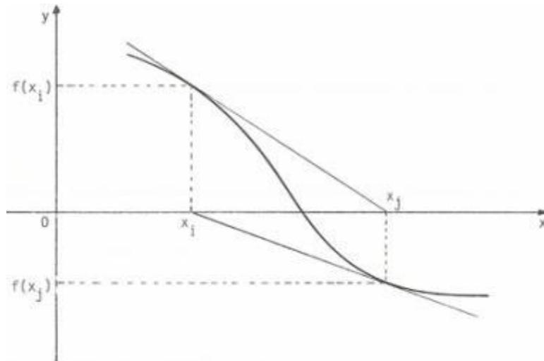
Si la fonction  $f$  est donnée analytiquement, sa dérivée peut-être déterminée analytiquement. Mais dans bien des cas, il est utile, voire indispensable de remplacer  $f'(x_n)$  par le quotient différentiel:
