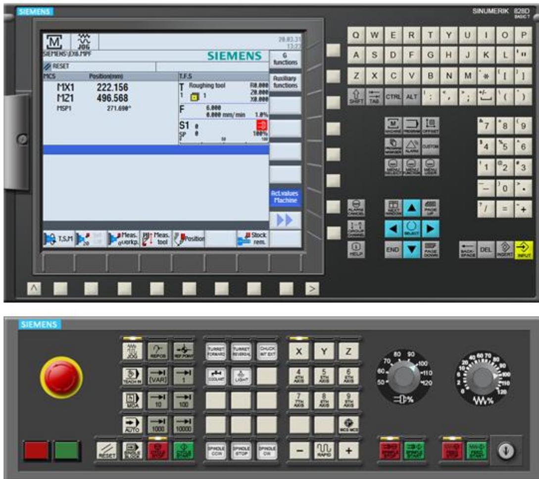
Figure II-3 : Différentes configurations des pupitres des MOCN
