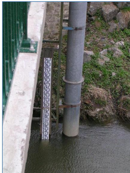
**Figure 10 :** Echelle limnimétrique
