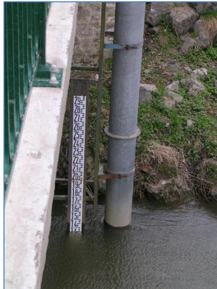
Figure 17 : Echelle limnimétrique
