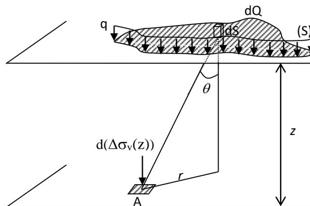
**Figure 15. Cas d'une charge répartie**
