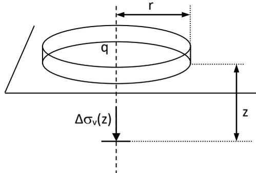
Figure 16. Cas d'une charge circulaire
