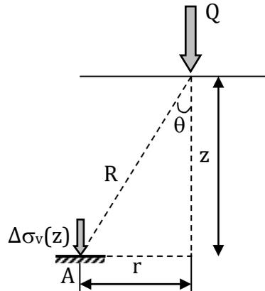
**Figure 12. Application d'une charge ponctuelle**
