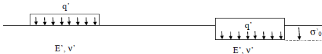
Figure 28. Semelles rigides fondées dans un milieu élastique semi-indéfini.
