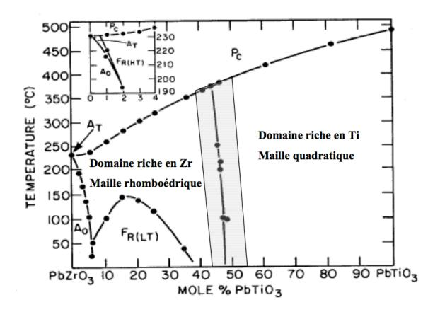
Figure I-6 - Diagramme de phase du  $Pb(Zr_x,Ti_{1-x})O_3$  tiré de Jaffe et al.  $^9$  la zone grisée est la zone morphotropique
