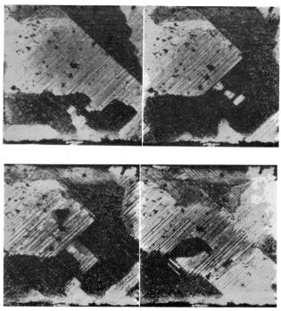
Domaine électrique dans un cristal de BaTiO3 et action du chamo électrique
