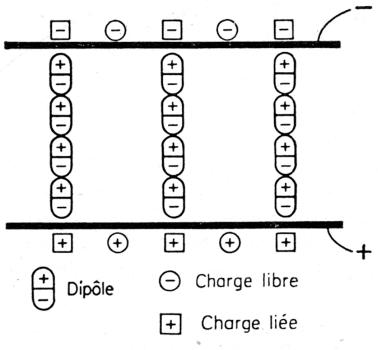
Représentation schématique de la polarisation diélectrique.
