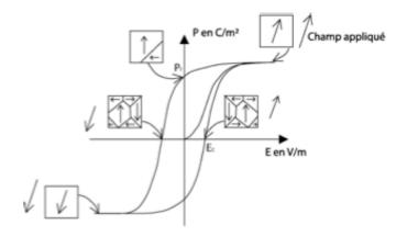
Figure I-3 - Cycle d'hystérésis d'un matériau ferroélectrique
