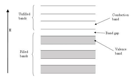
La faculté d'un matériau à être isolant peut aussi être expliquée par la notion de bandes d'énergie. L'isolation électrique est rattachée à une grandeur physique mesurable, la résistance, qui s'exprime en ohms (symbole :  $\Omega$ ).
