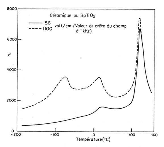
Constante diélectrique d'une céramique au titanate de baryum en fonction de la température (Mesures de W. B. Westphal, laboratoire de recherches sur les isolants).
