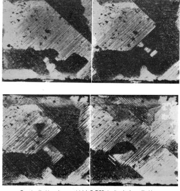
Domaine électrique dans un cristal de BaTiO3 et action du chamo électrique
