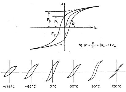
Boucle d'hystérésis ferroélectrique.
