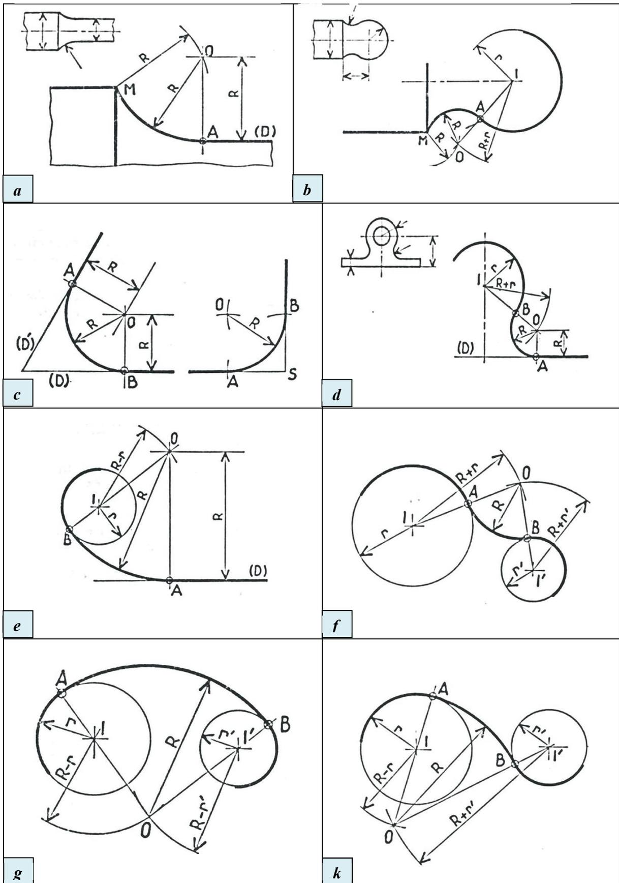
Fig. 2.5. Tracés géométriques des raccords.
