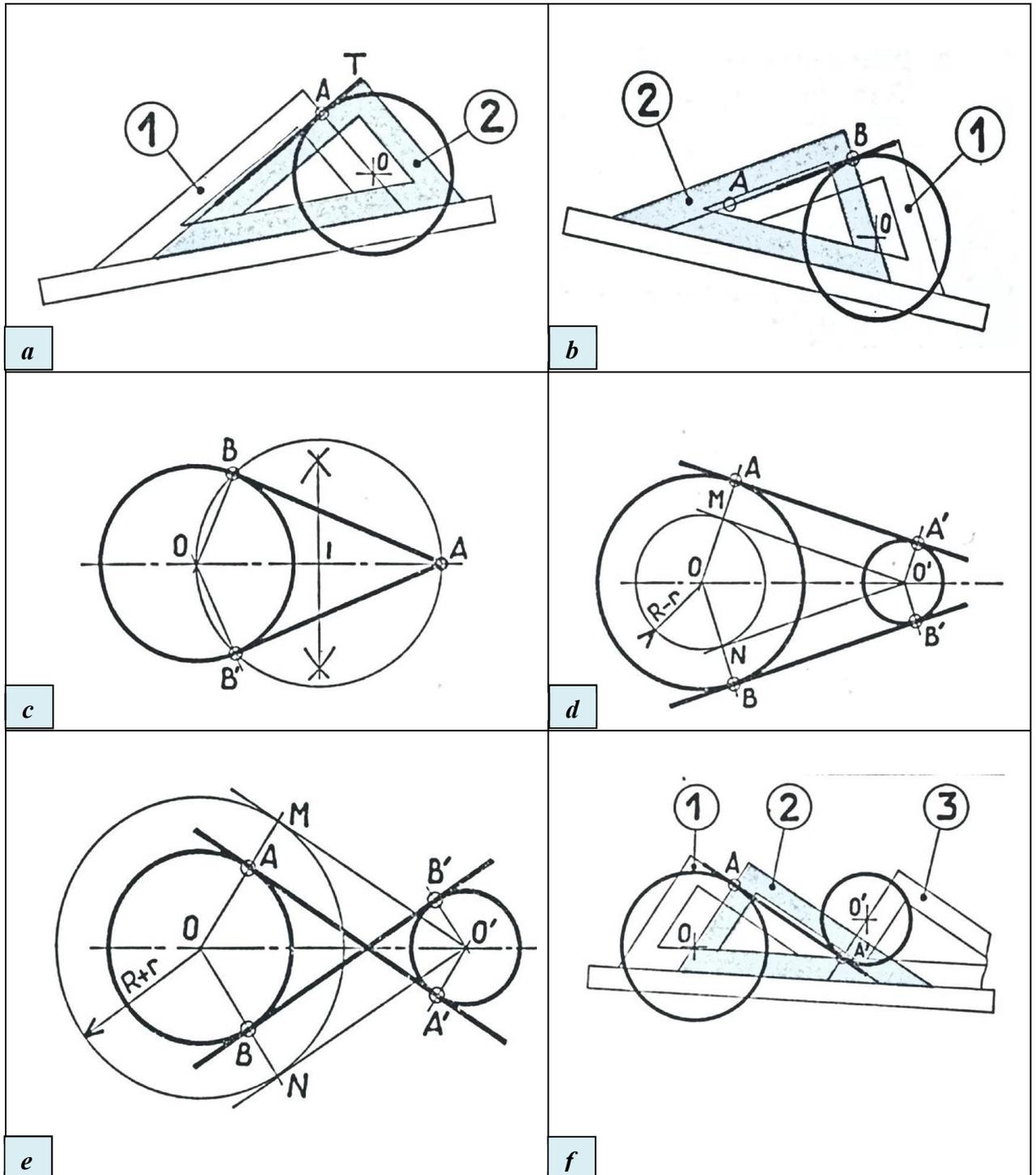
Fig. 2.4. Tracés géométriques des tangentes.
