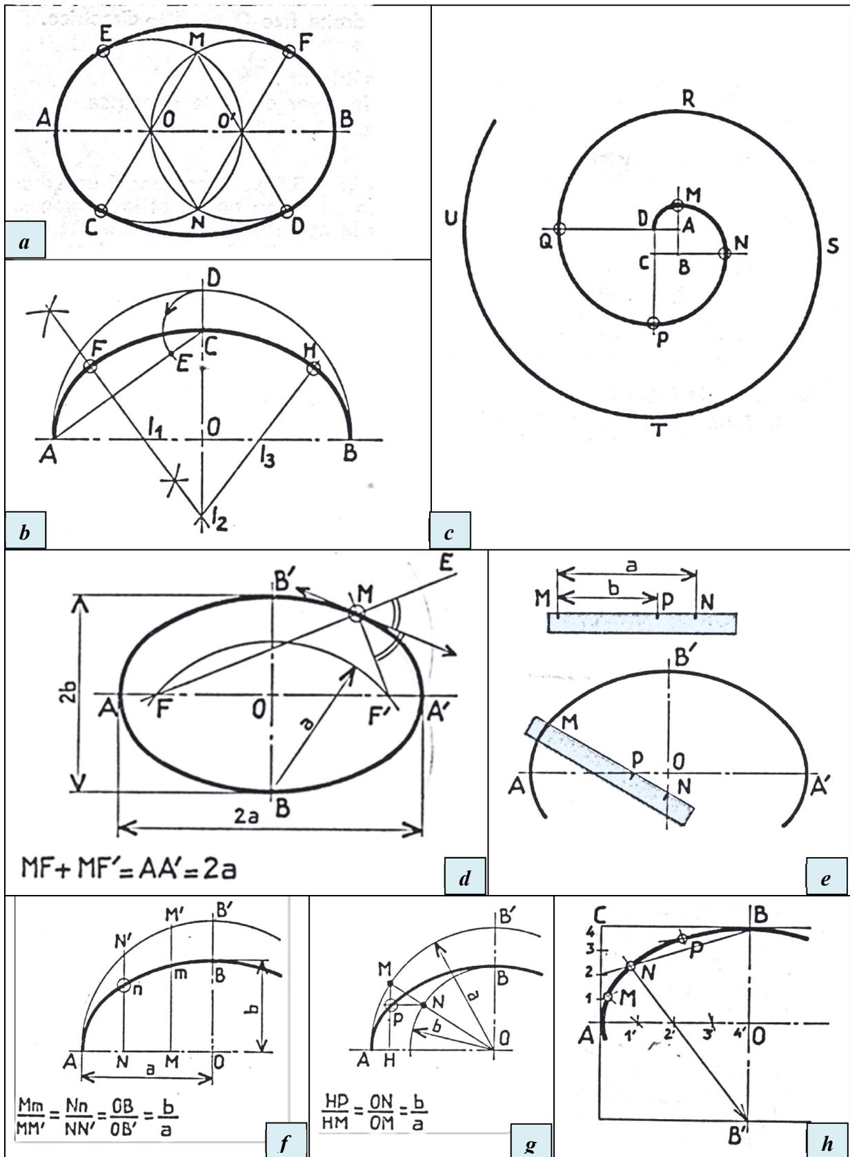
Fig. 2.6. Tracés géométriques des courbes usuelles
