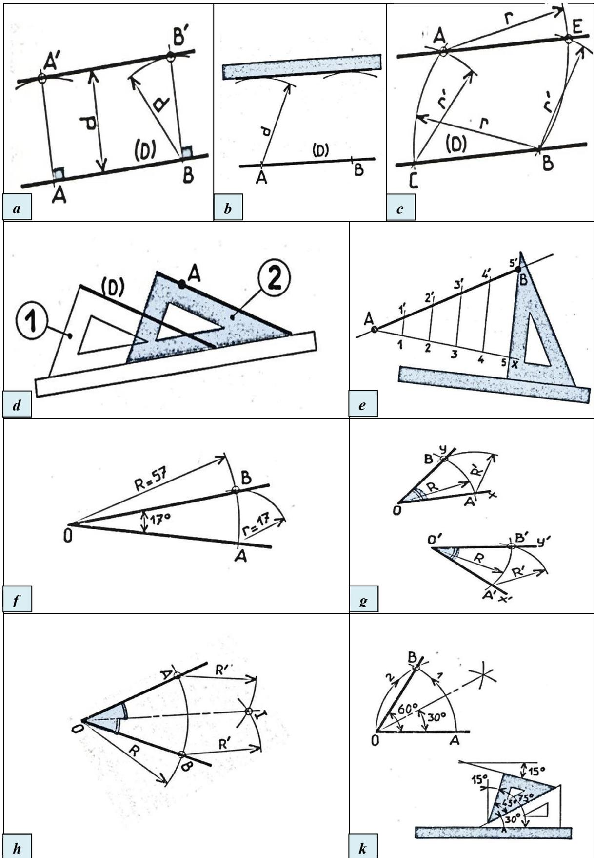
Fig. 2.2. Tracés géométriques des parallèles et angles.
