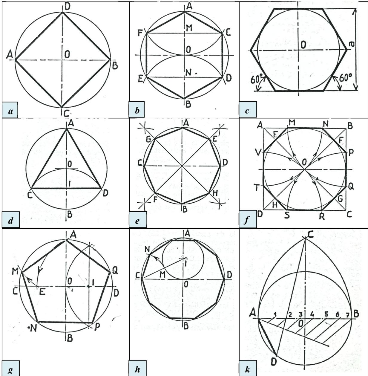
Fig. 2.7. Tracés géométriques des Polygones réguliers
