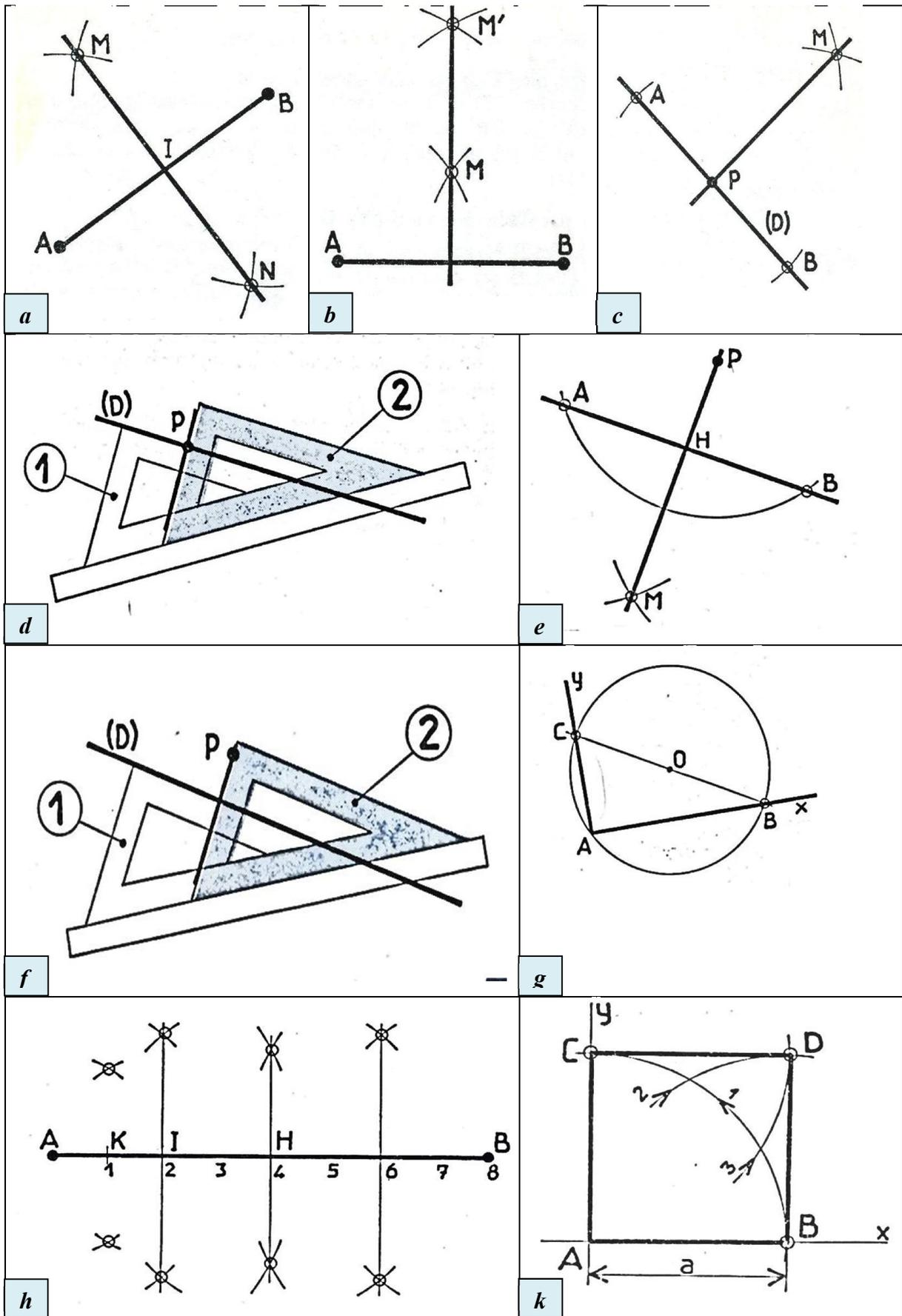
Fig. 2.1. Tracés géométriques des perpendiculaires.
