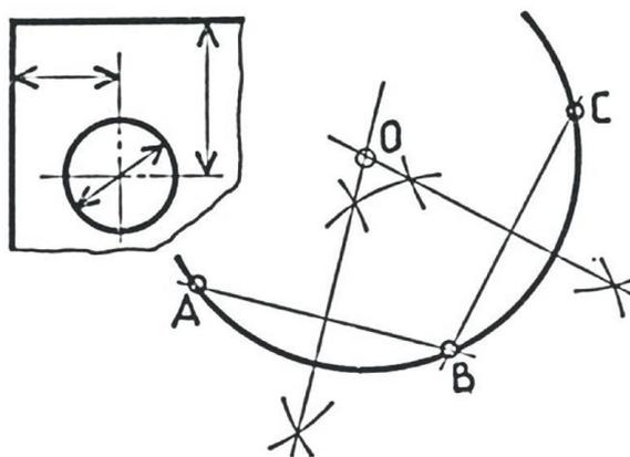
Fig. 2.3. Tracés géométriques de circonférence passant par 3 points.
