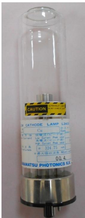
**Fig.4.** Lampe à cathode creuse (cathode en cuivre).
