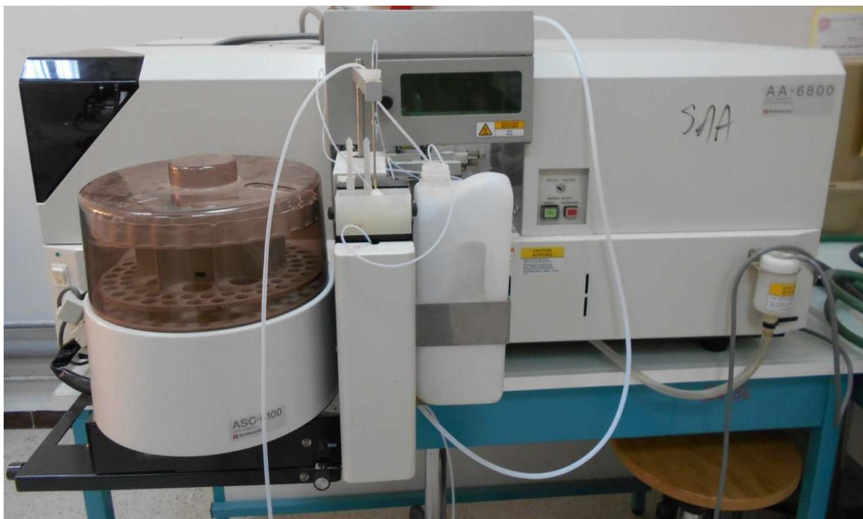
**Fig.6.** Photo d'un spectromètre d'absorption atomique de flamme (Shimadzu 6800) et équipé d'un four en graphite.
