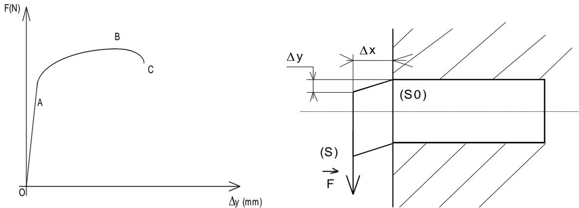
Figure 3.3 diagramme de l'essai de cisaillement
