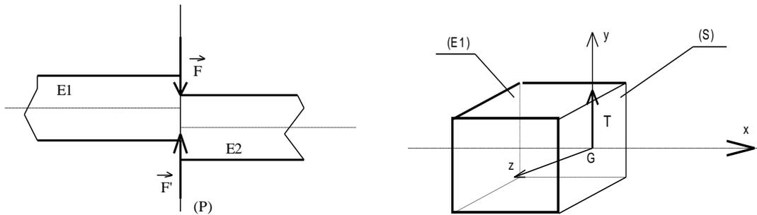
Figure 3.1 pièce sollicité en cisaillement et élément isolé
