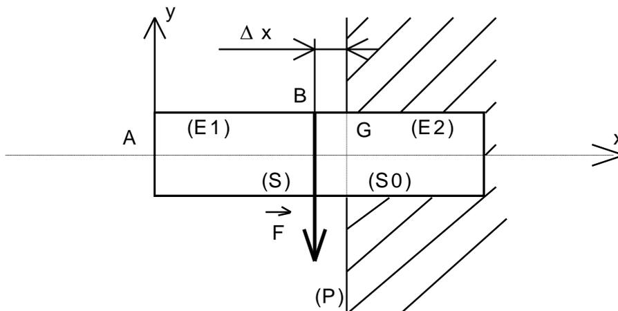
Figure 3.2 : essai de cisaillement
