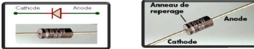
**Figure (1.7) :** Diode à jonction PN
