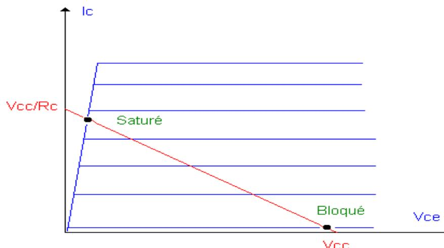
**Figure (1.15) :** Droite de charge et point de fonctionnement du transistor bipolaire
