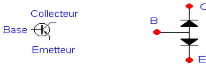
**Figure (1.11) :** Symbole électrique d'un transistor NPN
