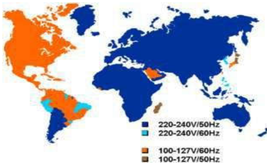
Figure (2.1) : la fréquence du réseau électrique
