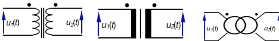
Figure (2.5) : Symbole électrique d'un transformateur
