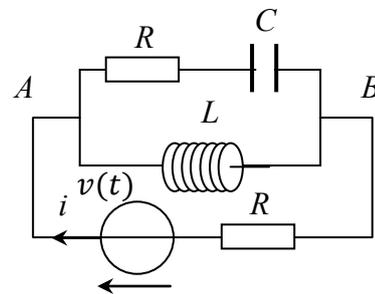
1. Exprimer l'impédance complexe  $Z_{AB}$  entre A et B en fonction de  $R$ ,  $L$ ,  $C$  et  $\omega$ . Mettre le résultat sous forme de  $a + jb$ . En déduire  $L$  pour que  $Z_{AB}$  soit une résistance pure ( $Z_{AB} = R_{AB}$ ). Quelle est alors l'expression de  $R_{AB}$  lorsque cette condition est remplie ?
