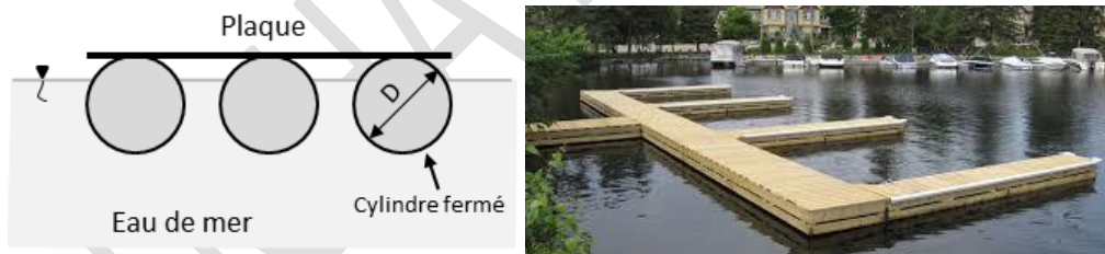
Figure 2.9 : Quai flottant basé sur le principe d'Archimède
