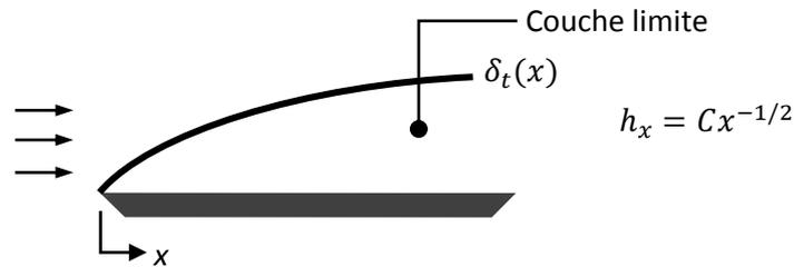
Déterminez le rapport entre le coefficient moyen de transfert thermique entre l'origine et un point d'abscisse  $x$  et le coefficient local de transfert thermique au point  $x$ .
