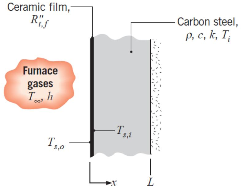
Au démarrage du processus, la paroi en acier a une température  $T_i=300 \text{ K}$ , pour une température des gaz chauds entrants  $T=1300 \text{ K}$ . Ce qui fournit un coefficient de transfert par convection  $h=20 \text{ W/(m}^2.\text{K)}$  entre la couche de céramique et les gaz chauds. Déterminez le temps mis pour que la paroi en acier atteigne la température  $T_{s,i}=1200 \text{ K}$ . En déduire la température  $T_{s,o}$  de la face exposée de la paroi en céramique à cet instant.
