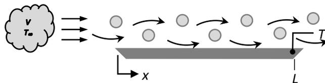
Évaluez le coefficient moyen de transfert thermique  $\bar{h}_L$  sur toute la longueur de la surface plane. En déduire le rapport entre le coefficient moyen et le coefficient local thermiques à une abscisse  $L$ .
