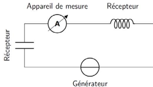
Un réseau électrique est constitué d'un ensemble de dipôles linéaires ; ceux-ci sont reliés par des fils de résistance négligeable. Le réseau est formé de branches, reliées entre elles par des nœuds, et formant des mailles. L'ensemble est appelé graphe du réseau.
