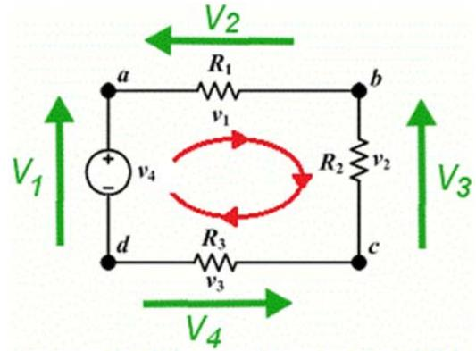
$$+V_1 - V_2 - V_3 - V_4 = 0$$
