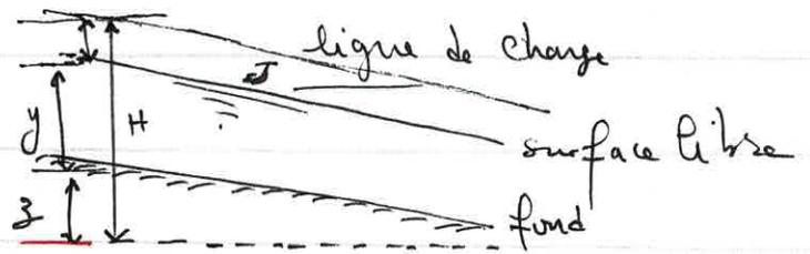
Le théorème de Bernoulli exprime que dans un écoulement permanent d'un fluide parfait ( $\nu = 0$ ), la charge  $H$  est constante le long de courant. Mais nous nous intéressons à des liquides réels et donc visqueux.
