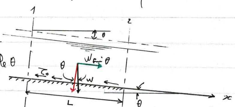
Force sur la surface  $A_{11}$  - face sur  $1$ , la surface  $A_{22}$   $2$  +  $W \sin \theta$  - force visqueuse = 0
