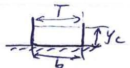
La condition d'écoulement critique (7)  $\frac{Q^2 b}{g b^3 y_c^3} = 1 \Leftrightarrow y_c = \sqrt[3]{\frac{Q^2}{g b^2}}$
