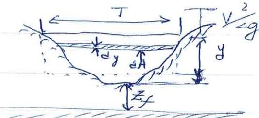
$y$  = tirant d'eau,  $z_f$  = cote du fond,  $A$  = la section mouillée la section transversale et  $v$  = vitesse moyenne dans la section  $A$
