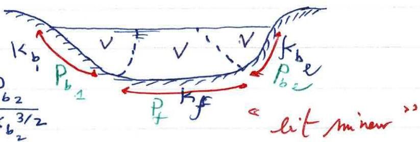
**Exemple d'application:** Pour une hauteur de berges de 2 m, une largeur du fond de 30 m, un coef de rugosité du fond  $K_f = 35 m^{1/3} s^{-1}$  et des berges  $K_b = 20 m^{1/3} s^{-1}$ , on obtient:
