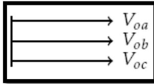
**Figure II.4 : Système homopolaire**
