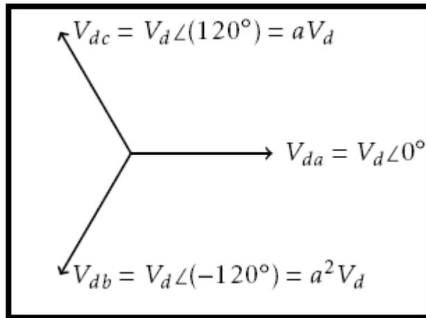
Figure II.3 : Système direct
