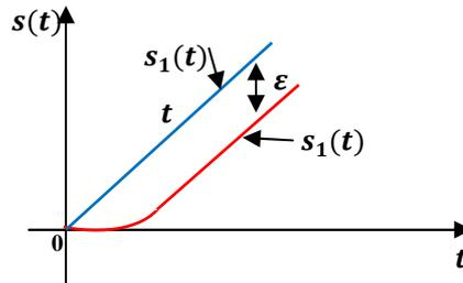
Figure 2.6 Réponse à une rampe d'un système du premier ordre
