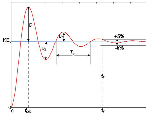
Figure 2.7 Réponse oscillatoire amortie d'un système du second ordre
