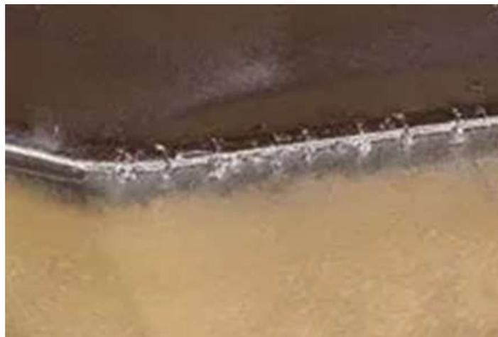
Figure III.5 : fissures thermiques
