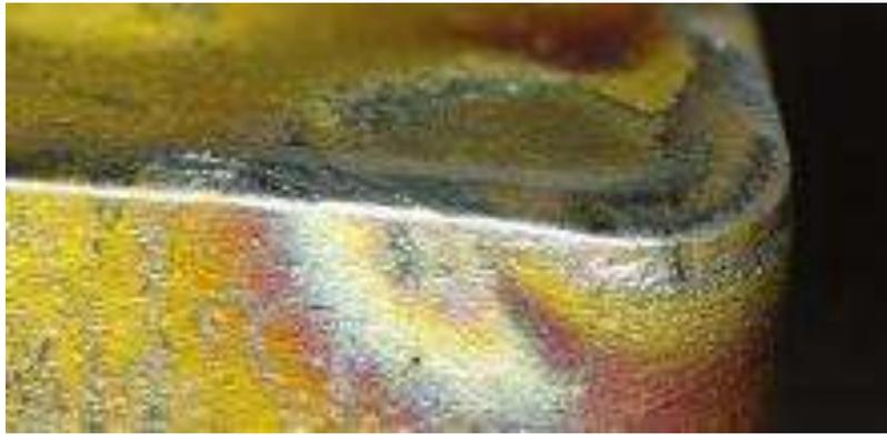
Figure III.6 : Déformation plastique
