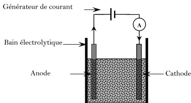
Figure 1 : Schéma synoptique d'une cellule électrolytique M.
