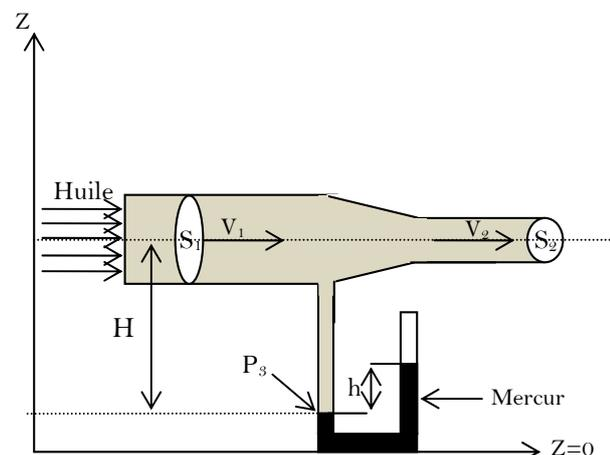
Le débit volumique du fluide dans la première section  $S_1$  est  $Q_{v1} = 0.4 \text{ l/s}$ , le diamètre de la première section  $D_1 = 10 \text{ mm}$  et la masse volumique de l'huile  $\rho_{\text{huile}} = 800 \text{ kg/m}^3$ ,  $v_2 = 20 \text{ m/s}$ .
