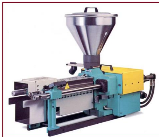
Figure II.3. Unité d'injection (ponton)
