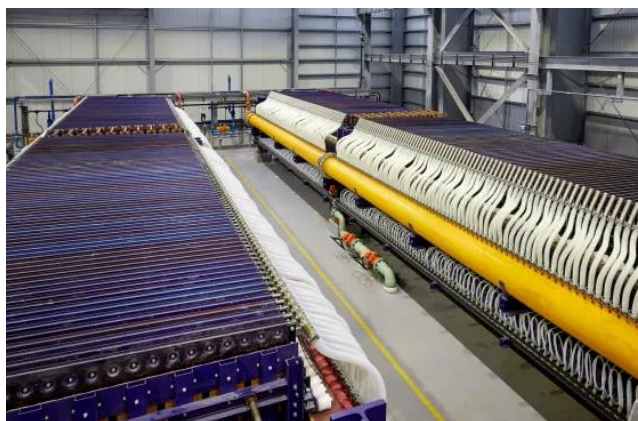
Fig. 4. - Électrolyseurs modulaires à cellules à membrane
