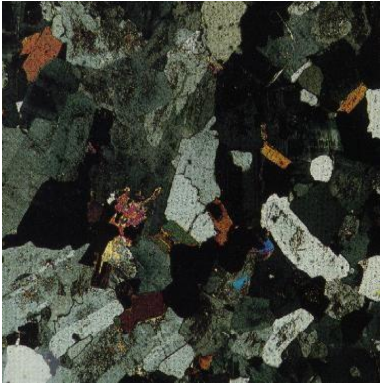
Structure imbriquée d'un granit
