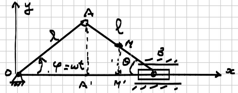
1°/⊗ La manivelle OA exécute un mouvement de rotation avec une vitesse angulaire  $\omega = \text{constante}$
