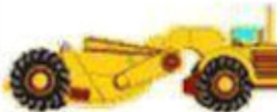
SCRAPER Décapage Transport Épandage
