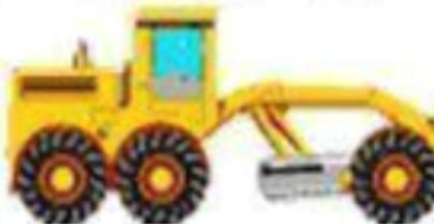
NIVELLEUSE Nivellement Réglage des pentes
