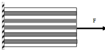
Figure 1 : Composite à fibres continues unidirectionnel mince ; en gris les fibres, en blanc la matrice.
