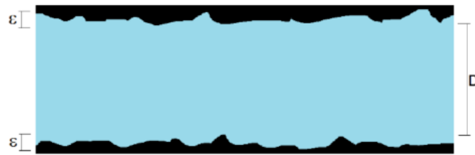
Figure IV.11 : Les aspérités de la surface intérieure d'une conduite
