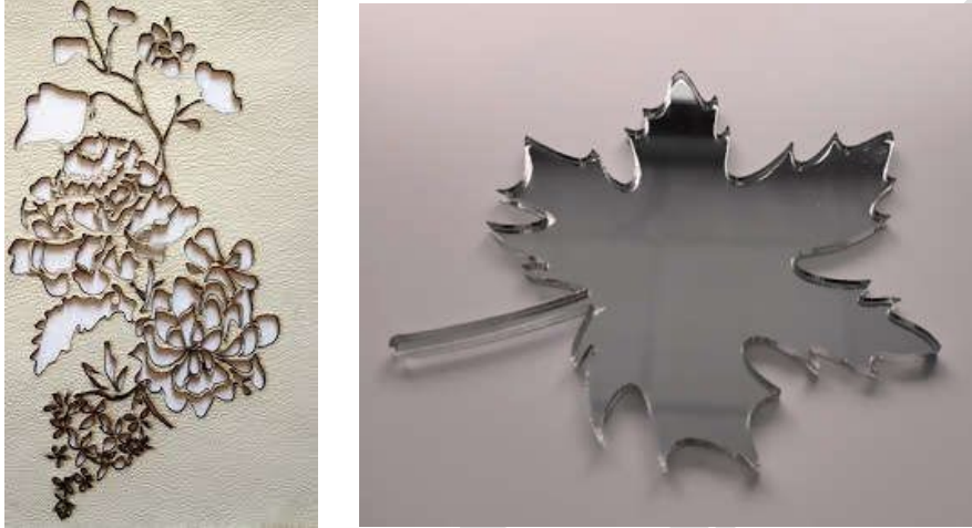
Fig.3.2. Exemple de forme réalisé au laser à source CO 2 .
