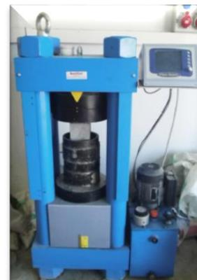
**Figure IV.21 : Presse hydraulique.**
