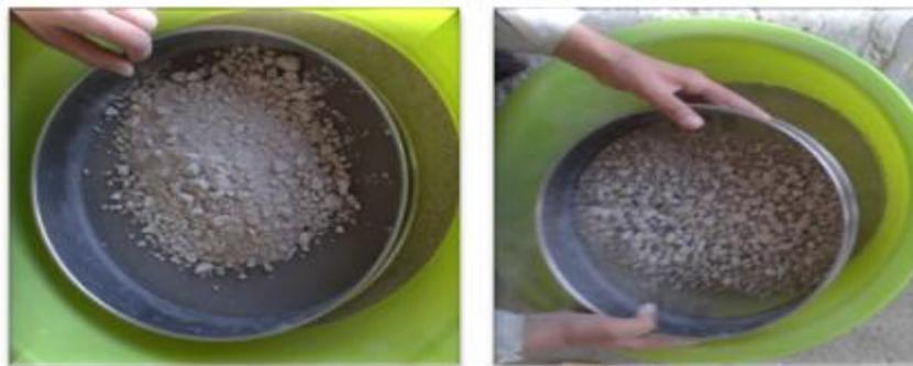
**Figure IV.8:** tamisage de gravier concasse et recycle avec un tamis 1.6 mm.
