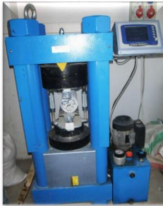
**Figure IV.24** : Essai de traction par fendage.
