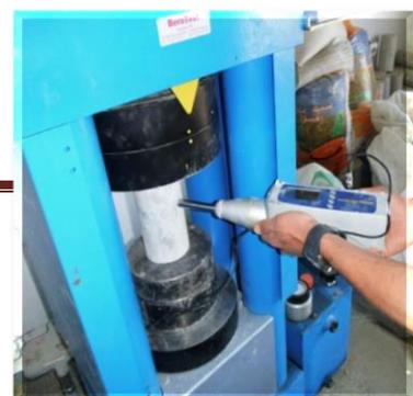
MPa) jusqu'à la charge de 10KN, puis on fait l'essai sclérométrique horizontal (10 coups).
