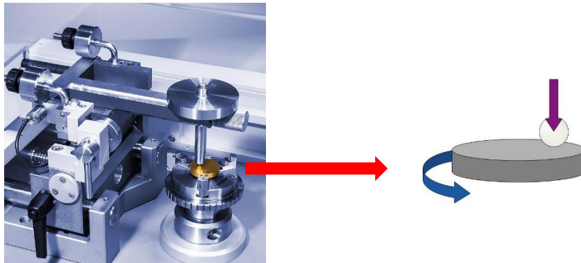
Figure III.23. Principe d'essai de frottement bille sur disque rotatif
