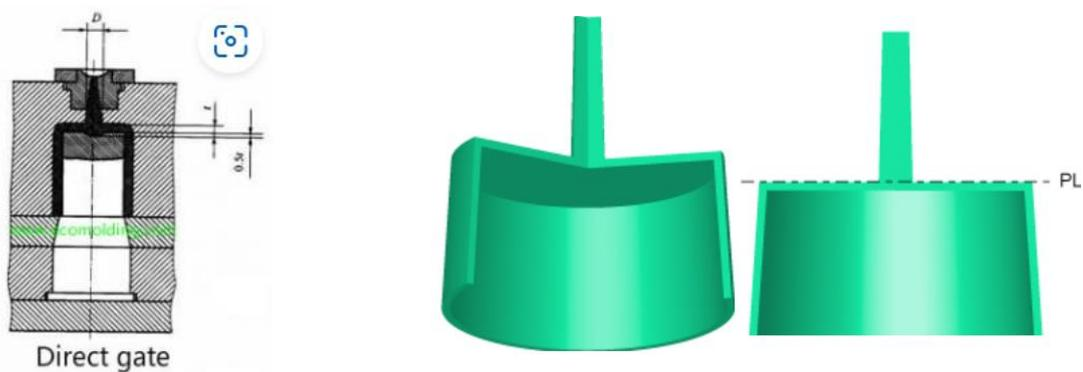
Figure III.4. Seuil en masse ou direct
