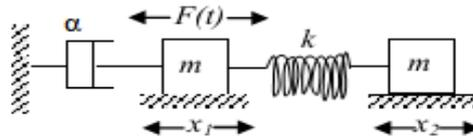
**Figure 2 :** Système mécanique forcé à deux degrés de liberté.
