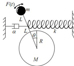
**Figure 1 :** Système mécanique forcé à un degré de liberté.
