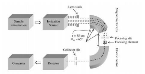
Le rayan de courbure r de la trajectoire d'un ion de masse m et de charge z dépend donc du champ magnétique et de potentielle d'accélération.
