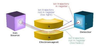
Principe de fonctionnement d'un analyseur magnétique:
