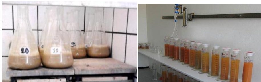
Figure 1: Etape de destruction des ciments puis celle de prélèvement à la pipette de Robinson
