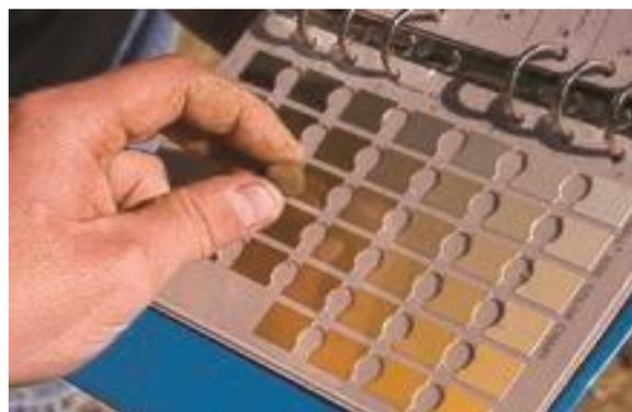
Figure 8 : Détermination des couleurs des sols
