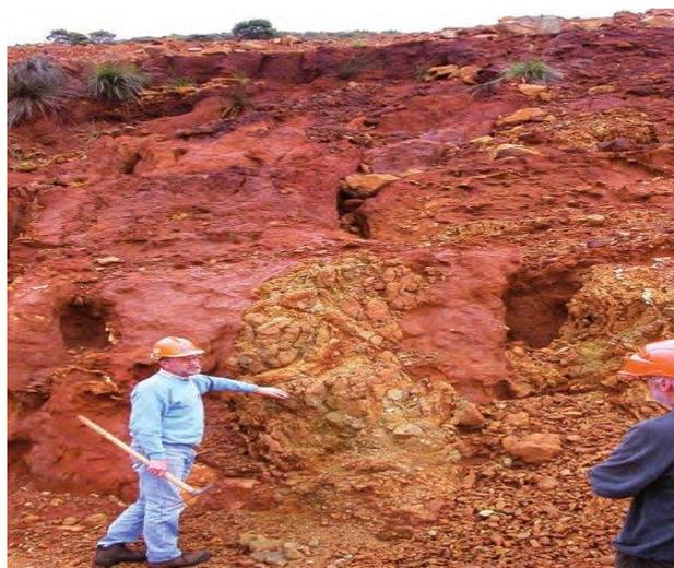
**Figure 2 : Exemple d'un sol ferrallitique**
