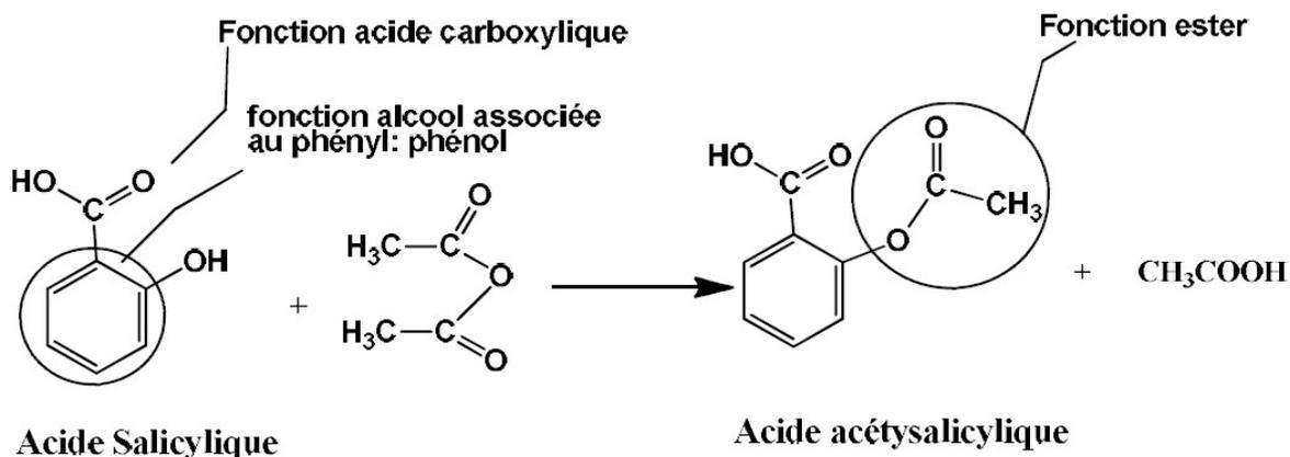
La réaction a lieu sans solvant et l'aspirine brute est séparée du catalyseur et de l'acide acétique formé par lavage avec de l'eau (où l'aspirine est peu soluble) et recristallisée dans un mélange éthanol / eau
