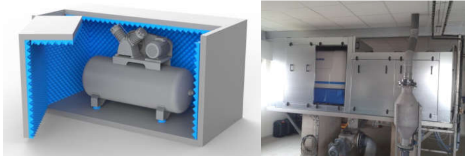
Figure IV.3 : Capotage d'une source de bruit
