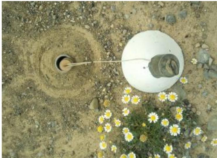
**Figure(IV.11)** Thermomètre au sol
