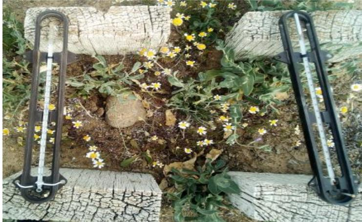
**Figure(IV.7)** Thermomètre à maxima-minima au dessus de sol
