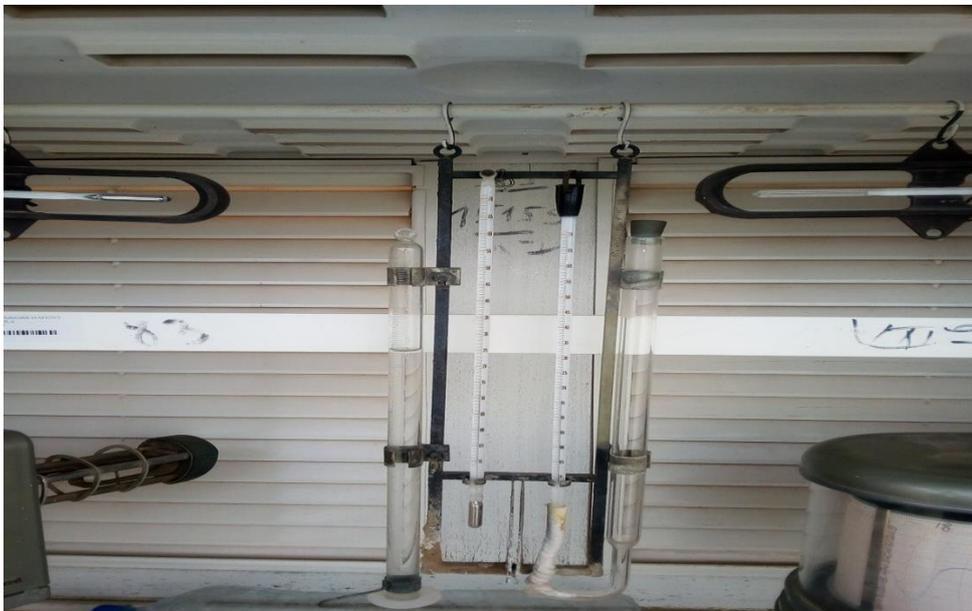
**Figure(IV.4)** Thermomètre à mercure de l'abri météorologique.
