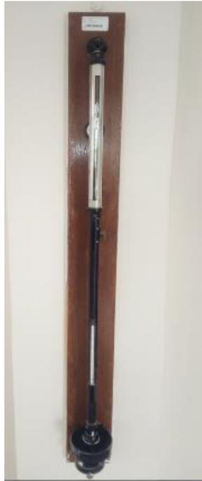
**Figure(IV.8)** baromètre à mercure de la station météorologique de Msila.
