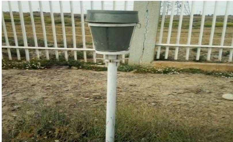
**Figure(IV.10)** pluviomètre de la station météorologique de Msila.
