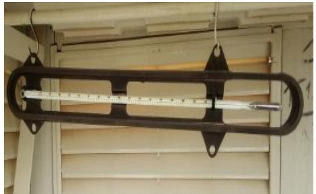
**Figure(IV.6)** thermomètre à maxima-minima sous –abri
