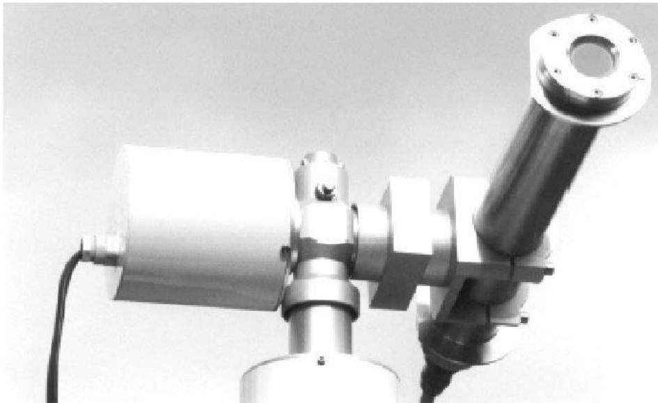
**Figure IV.14.** Appareil de mesure le rayonnement direct ; pyrhéliomètres
