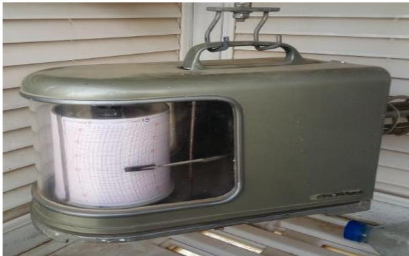
**Figure(IV.5)** thermographe de l'abri météorologique.
