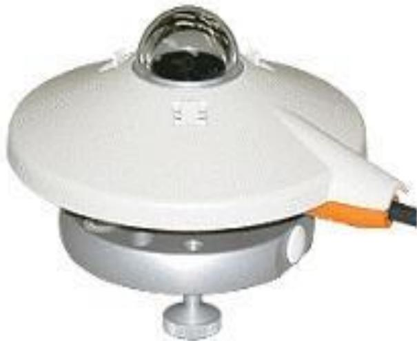
**Fig IV.16.** L'instrument qui mesure le rayonnement global ; Pyranomètre
