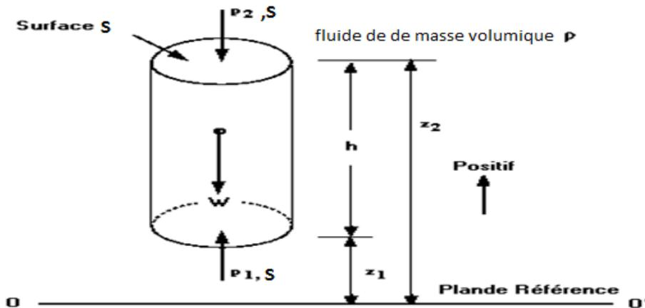
Soit un élément de fluide de masse volumique  $\rho$  représentant une colonne verticale de section transversale constante  $S$ . Considérons 2 sections situées à des distances  $Z_1$  et  $Z_2$  par rapport à un plan de référence  $OO'$ . Soient  $P_1$  et  $P_2$  les pressions dans ces 2 sections.
