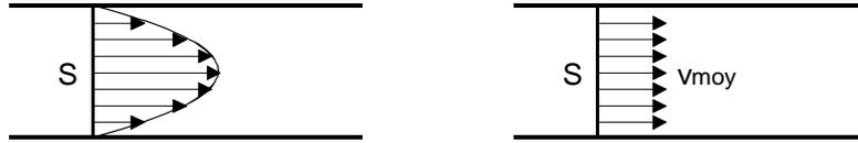
existe un **profil de vitesse** (à cause des forces de frottement).
