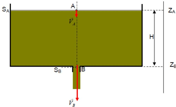
Le réservoir cylindrique représenté ci-dessus, ouvert à l'air libre, a une section  $S_A$  de diamètre  $D_A = 2$  m. Il est muni, à sa base, d'un orifice de vidage de section  $S_B$  et de diamètre  $D_B = 14$  mm. Le réservoir est plein jusqu'à une hauteur  $H = (Z_A - Z_B) = 2,5$  m de fioul, liquide considéré comme fluide parfait, de masse volumique  $\rho = 817$  kg/m<sup>3</sup>.
