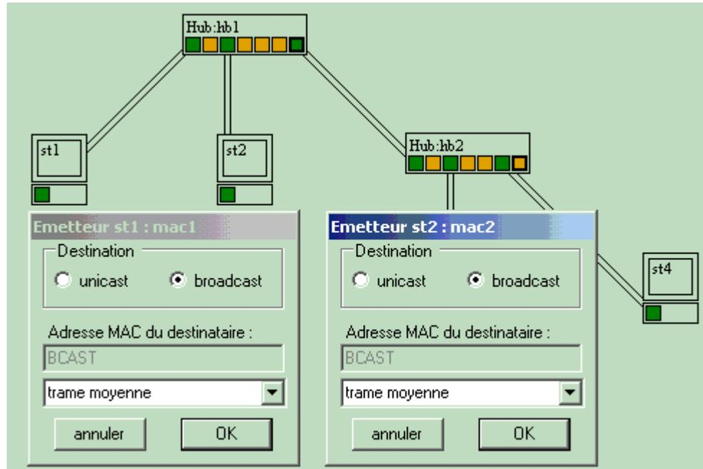
Test 1 : émettre les trames à partir de st1 et de st2 de manière simultanée.
