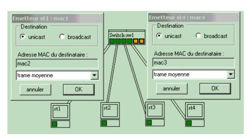
Test 1 : émettre les trames à partir de st1 et de st4 de manière simultanée.
